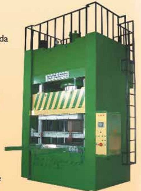
HLP 1000 Ton Kalıp sürücülü hidrolik lastik presi
