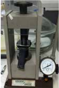
Şekil 2. a) Graseby Specac Marka Manuel Baskı Makinası
